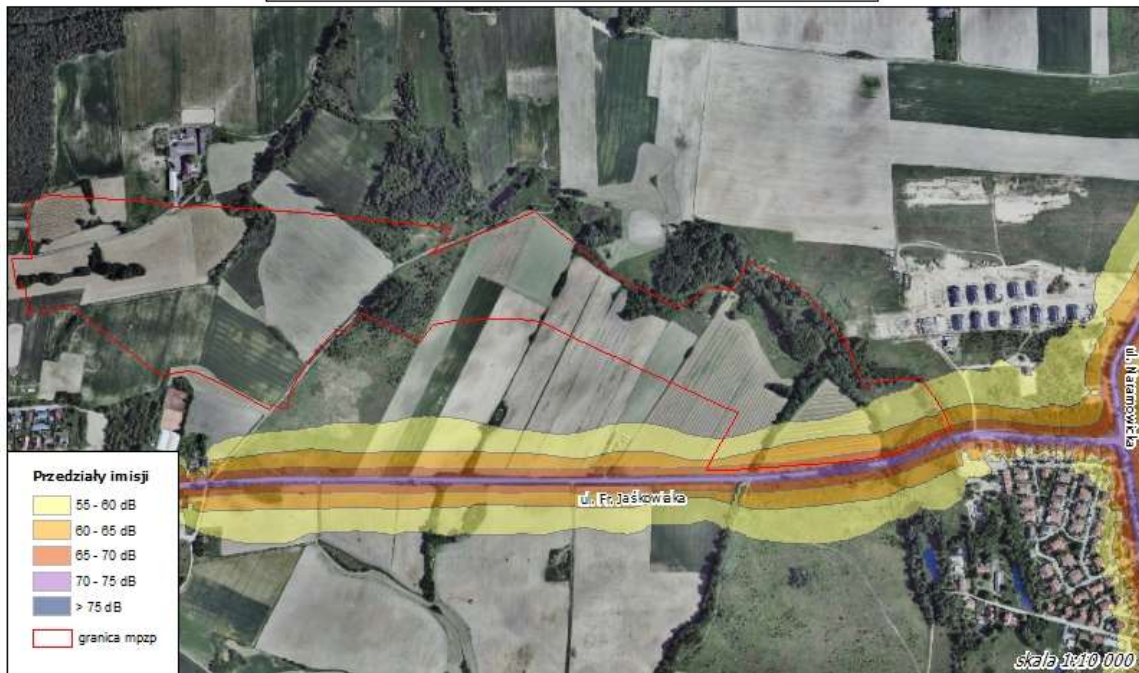
ZASIEGI ODDZIAŁYWANIA HAŁASU SAMOCHODOWEGO W PORZE DZIENNO-WIECZORNO-NOCNEJ (LDWN) - W STANIE ISTNIEJĄCYM W ROKU 2017
