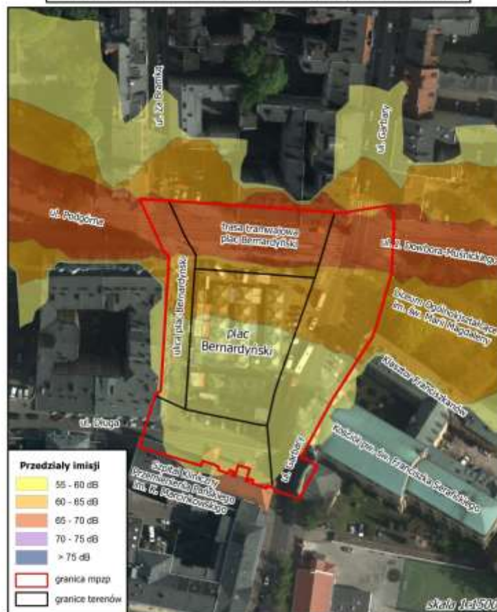
ZASIĘGI ODDZIAŁYWANIA HAŁASU TRAMWAJOWEGO W PORZE DZIEŃNO-WIECZORNO-NOCNEJ (LDWN) - W STANIE ISTNIEJĄCYM W ROKU 2017
